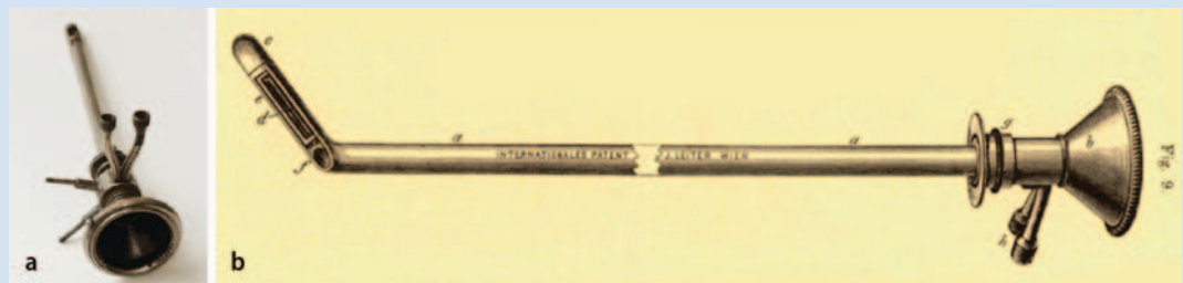
Abb. 7 ▲ a Nitze-Zystoskop („W.P. Didusch Center for Urologic History“, Linthicum, Repro T. Stevens; mit freundl. Genehmigung). b Schemazeichnung, Firmen katalog J. Leiter Wien (Nitze-Leiter-Forschungsgesellschaft für Endoskopie, Wien; mit freundl. Genehmigung)
